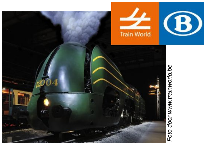
Pronkstuk van het museum: Stoomlocomotief type 12 1939, 89 ton, 2500 pk, max 140km/u.
